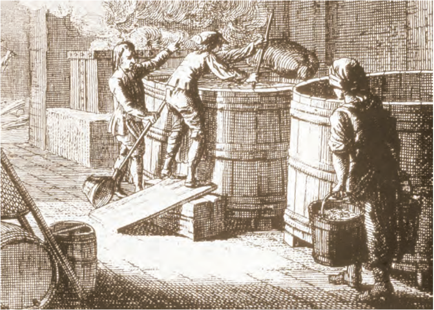
Die Arbeit im Sudhaus: Die historische Ansicht zeigt eine Szene des Braubetriebes, wie sie bis ins 19. Jahrhundert typisch war. In Eimern und Säcken werden die Zutaten herbeigebracht und im Sud in der Braupfanne verrührt.
